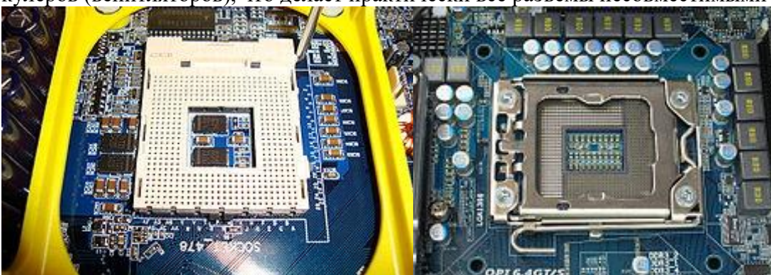
Рис. 2.4. Разъёмы центрального процессора Intel: Socket 478 (процессоры Pentium 4, Celeron) и LGA 1366 (процессоры Core i7, Xeon)
