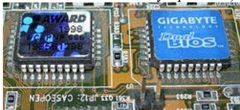
Рис. 2.11. Основная и дублирующая микросхемы ПЗУ материнской платы фирмы Gigabyte. На ПЗУ содержится код BIOS, созданный фирмой Award
