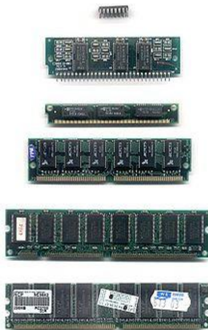
Рис. 2.7. Эволюционное развитие конструкции модулей памяти, используемые в качестве ОЗУ компьютера. Сверху вниз: DIP, SIPP, SIMM 30 pin, SIMM 72 pin, DIMM, DDR DIMM. Модуль памяти и, соответственно, разъем для установки модуля памяти в области подключения, имеют размер 133,35 мм (5j").
