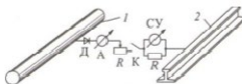
Рис. 2. Схема поляризованного дренажа ПГД: Д — диод; А — амперметр; R — резистор; К — ключ; СУ — сигнальное устройство; 1 — кабель; 2 — рельс
