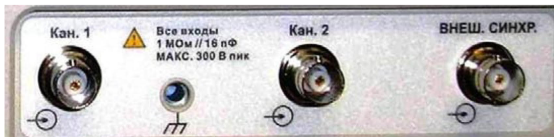
Рис. 5. Гнезда для подключения входных сигналов и внешней синхронизации
