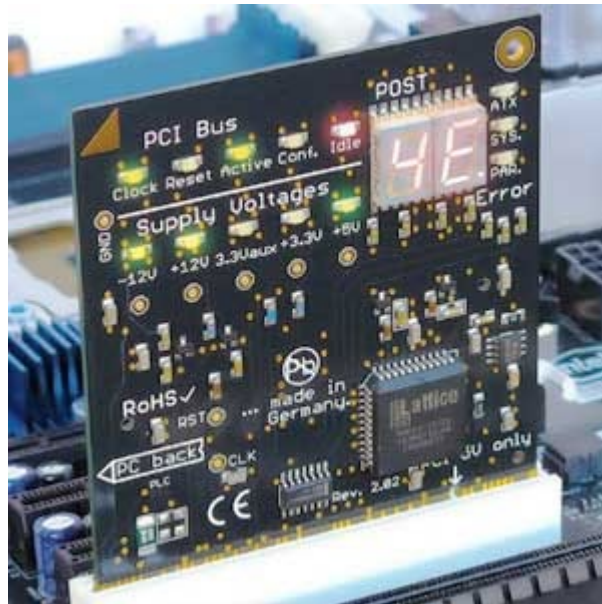
Рис. 1. Карта расширения, отображающая POST-коды в процессе загрузки
