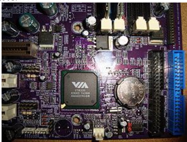
Рис. 2.6. Южный мост VIA 8235
