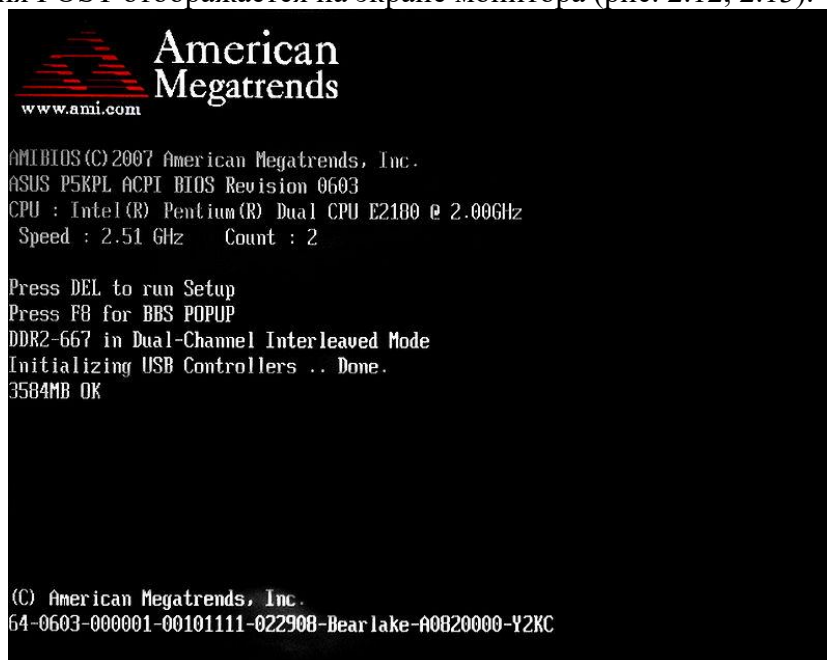
Рис. 2.12. Первый этап типичной операции POST (AMI BIOS)
