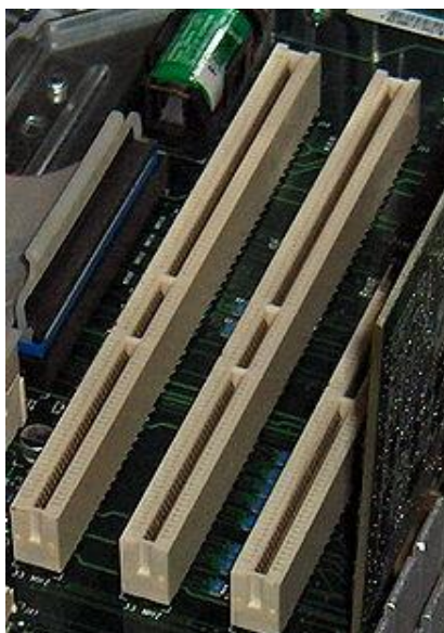
Рис. 2.9. Слоты расширения 64-разрядной шины PCI
