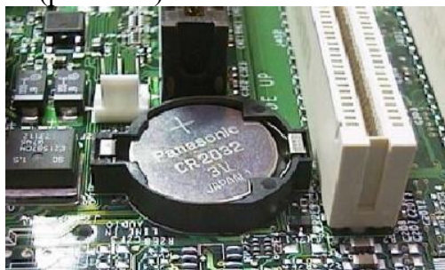
Рис. 2.14. Батарейка CR2032 на материнской плате
