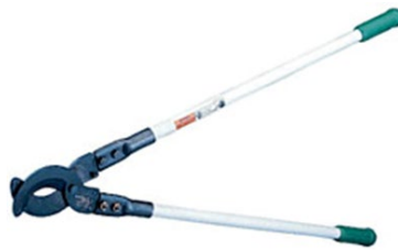
Рис. 6. Усиленный кабелерез для работы с кабелем связи. Позволяет перекусывать кабель толщиной до 57 мм в свинцовой, пластиковой и резиновой оболочке
