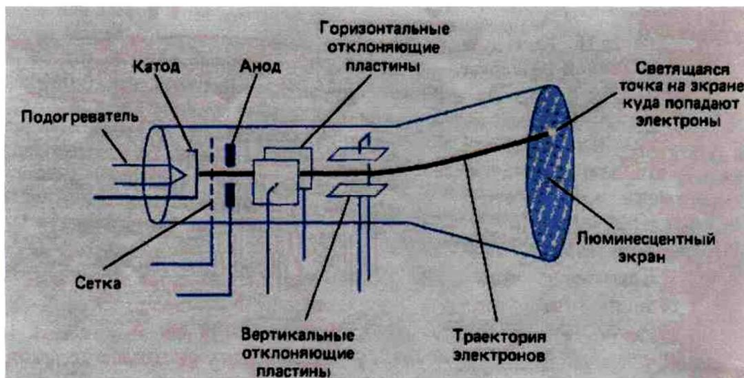
Рис.3. Электронно-лучевая трубка.
