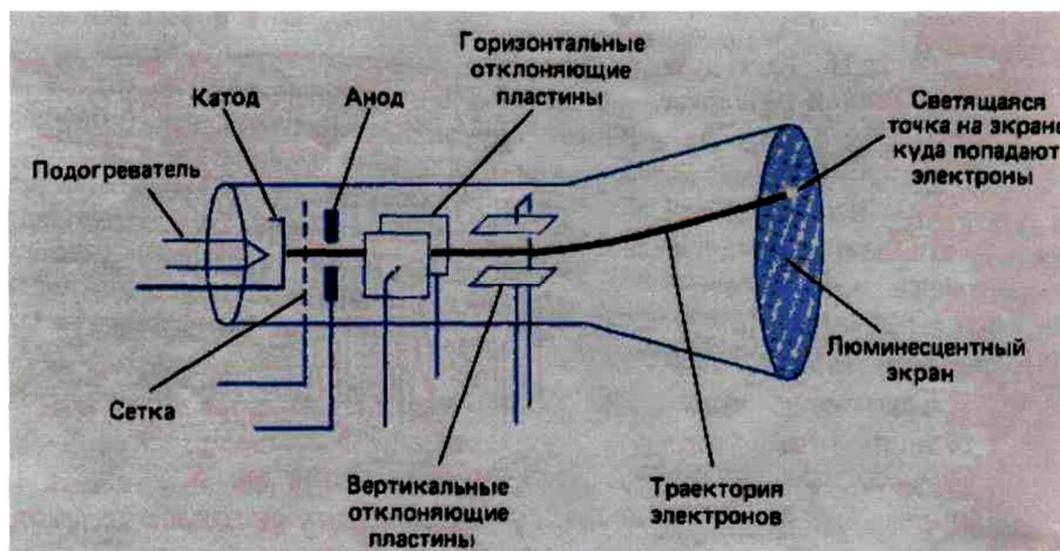
Рис.3. Электронно-лучевая трубка.
