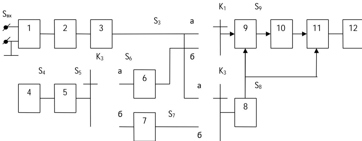
Рис.3. Структурная схема цифрового частотомера.
