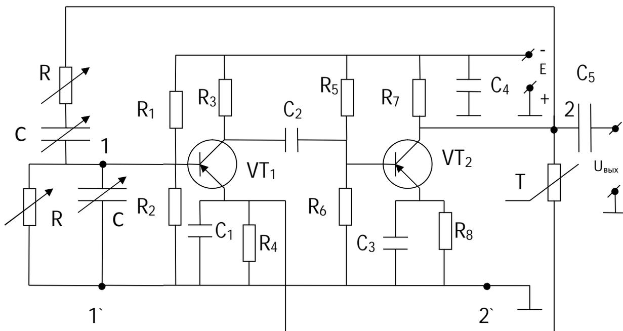
Рис.2. Схема задающего генератора типа «RC».
