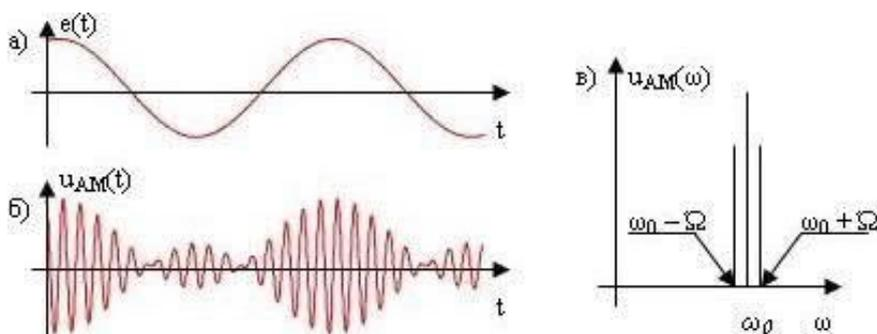
Рис.2. Тональная амплитудная модуляция при коэффициенте  $MA > 1$ :
