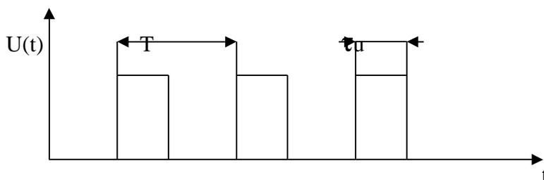
Рис.2. Последовательность импульсов с указанием параметров сигнала.
