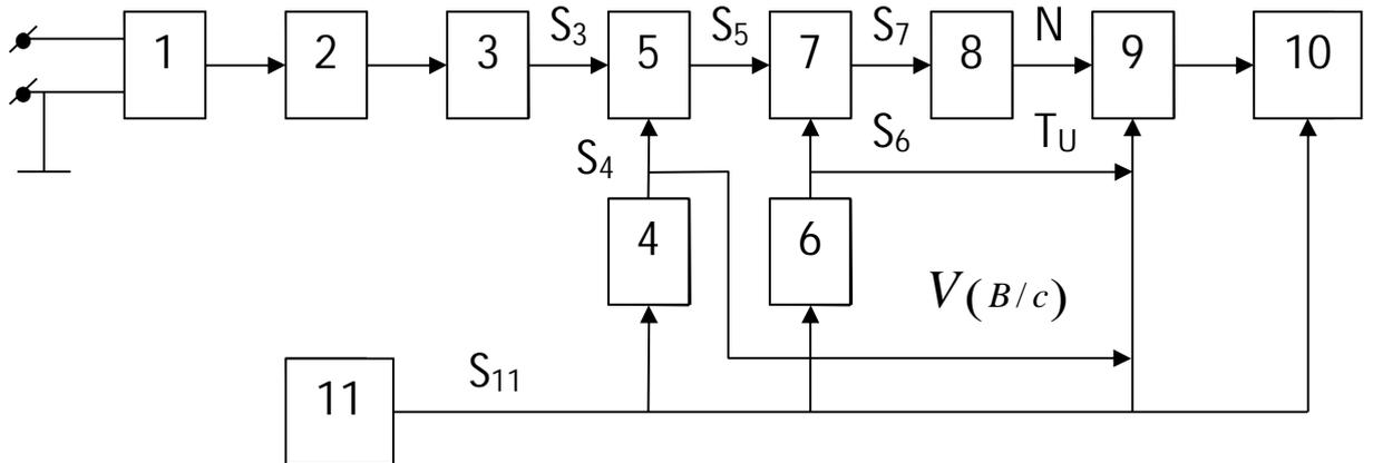
Рис.3. Схема цифрового вольтметра с время-импульсным преобразованием.
