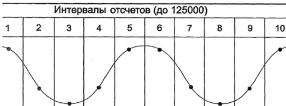
Рис. 3. Иллюстрация сбора данных в режиме «Стандартная выборка».
