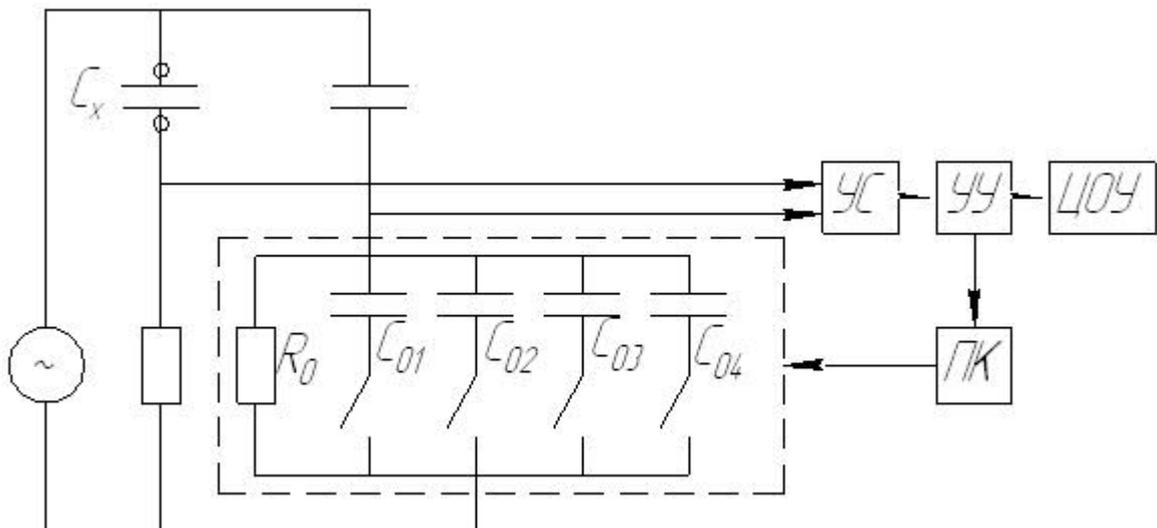
Рис.1. Схема цифрового уравнивающего моста.
