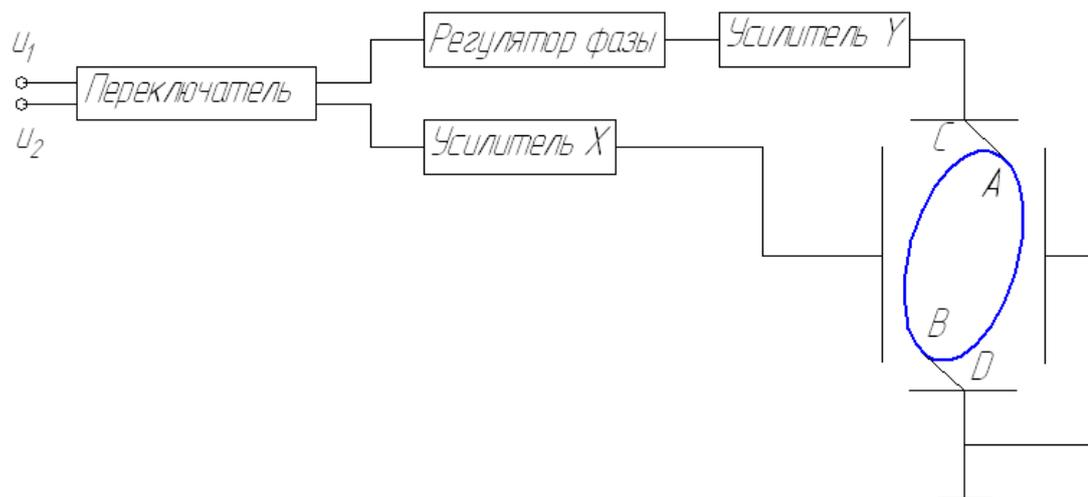
Рис.3. Структурная схема при измерении сдвига фазы методом синусоидальной развертки.
