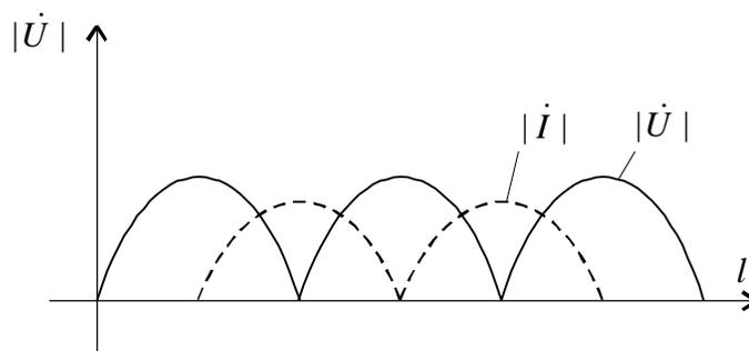
Рис.3. Стоячие волны тока и напряжения в линии.
