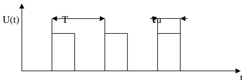
Рис.2. Последовательность импульсов с указанием параметров сигнала.
