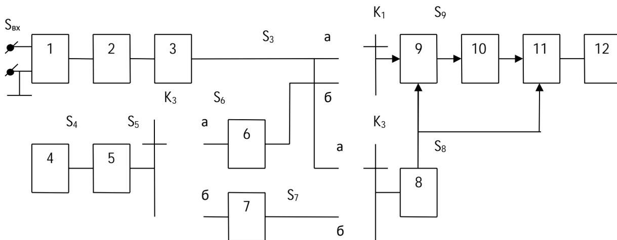
Рис.3. Структурная схема цифрового частотомера.
