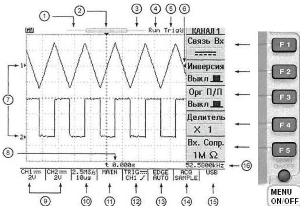
Рис. 6. Информационная картина на экране осциллографа и кнопки управления меню
