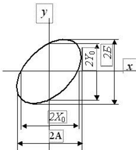
Рис.4. Осциллограмма фазового сдвига при синусоидальной развертке.
