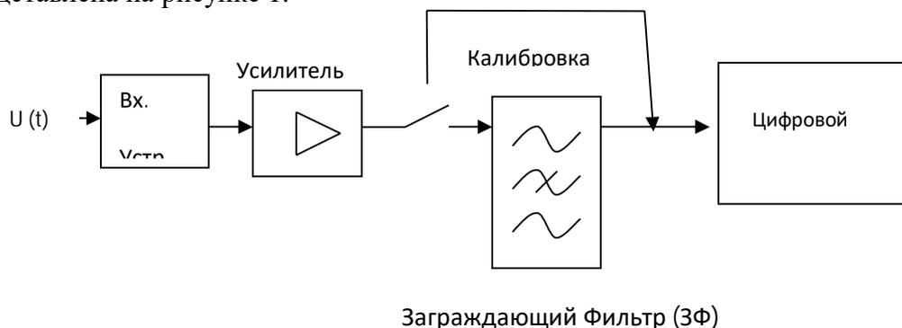
Рис.1. Упрощенная структурная схема измерителя коэффициента нелинейных искажений.
