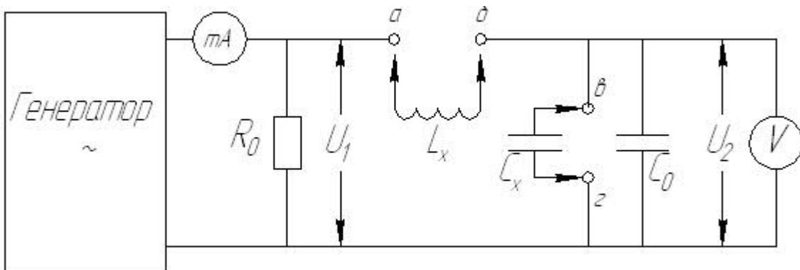
Рис.1. Схема куметра.
