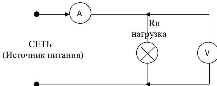
Рис. 1. Подключение вольтметра и амперметра.
