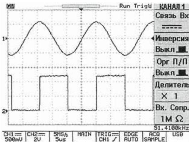
Рис. 8. Наблюдение сигналов по двум каналам, синхронизация по переднему фронту
