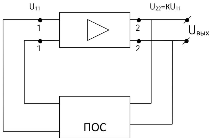
Рис.1. Обобщенная структурная схема генератора.
