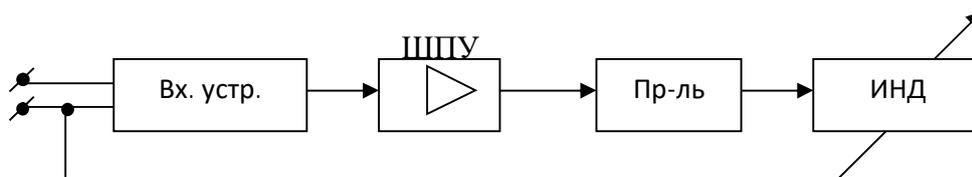
Рис. 1. Схема вольтметра типа усилитель-преобразователь
