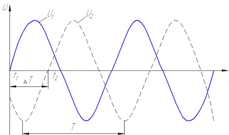
Рис.1. Временная диаграмма сдвига двух сигналов одинаковой частоты.
