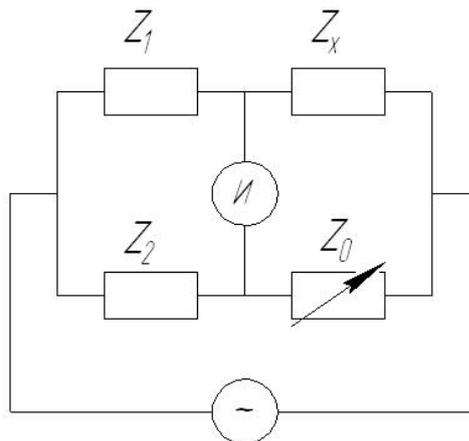
Рис.1. Обобщенная схема моста.
