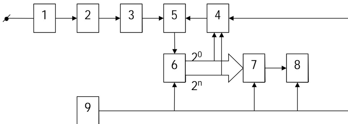
Рис.3. Схема цифрового вольтметра поразрядного уравнивания.
