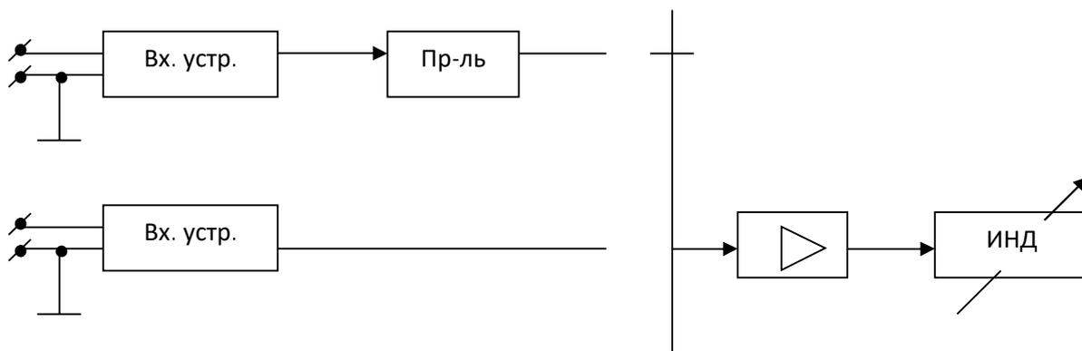
Рис.2. Схема универсального вольтметра, применяющегося при измерении постоянного и переменного напряжений.
