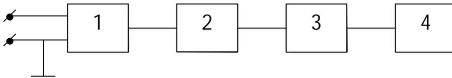
Рис. 1. Схема вольтметра типа преобразователь-усилитель.
