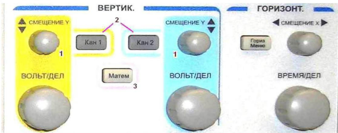
Рис. 7. Органы управления по вертикальной координате.
